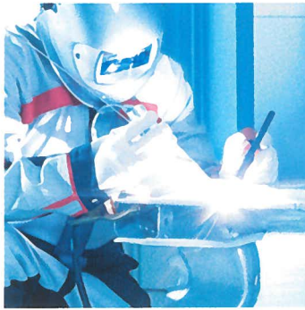
Schmelzschiessen ist ein geeignetes Verfahren zum Fügen von Aluminiumteilen
