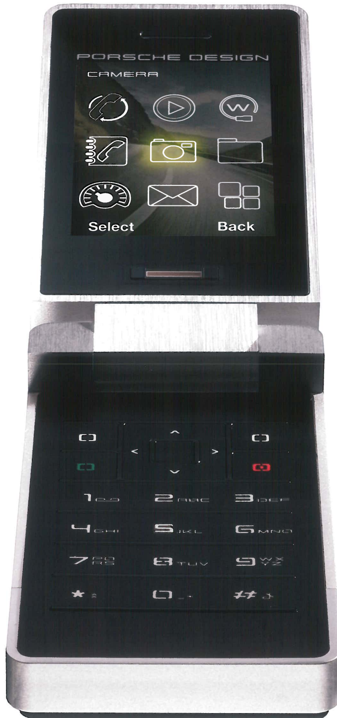
Hightech-Gehäuse Das Gehäuse des Mobiltelefons wird aus einem massiven Aluminiumblock gefräst. Ein doppeltes Aluminiumscharnier ermöglicht das Drehen des Bildschirms um 180 Grad.
